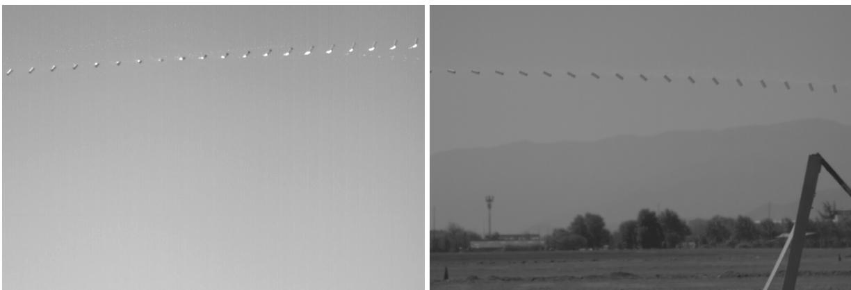
Figura 4. Secuencia de imágenes cada 6.5 ms de proyectiles únicos que van rotando al viajar de izquierda a derecha. En el caso de la izquierda se ve, además, el chorro de gas que impulsa levemente al proyectil hacia arriba.
